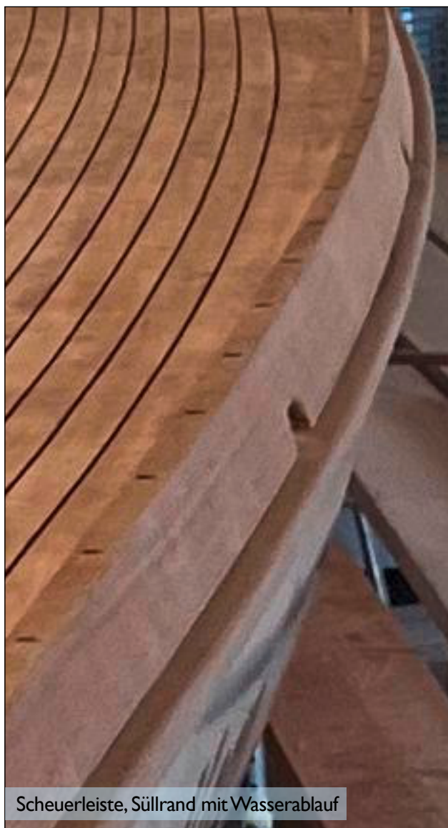
Scheuerleiste, Süllrand mit Wasserablauf (Modell 1:1)
