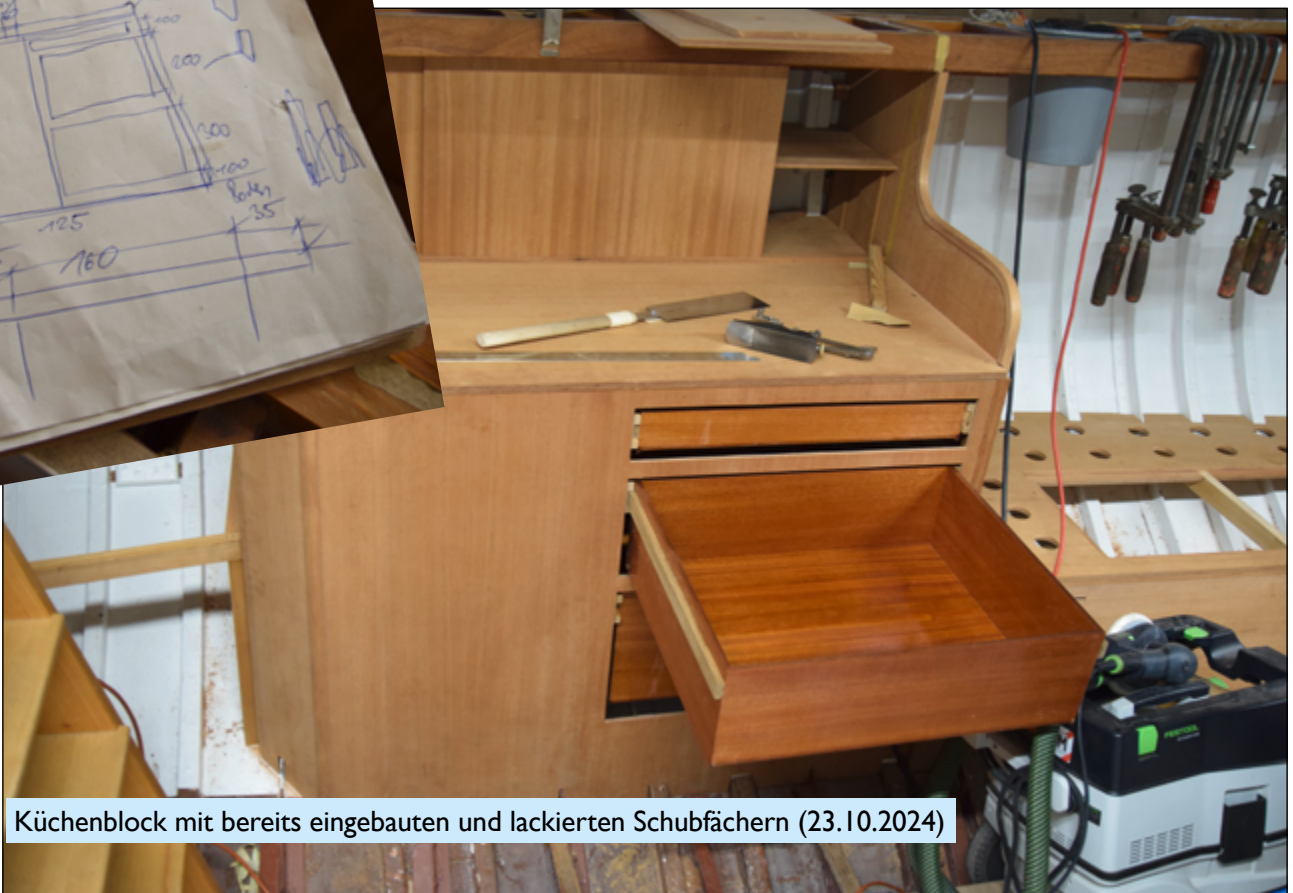
Küchenblock mit bereits eingebauten Schubfächern
