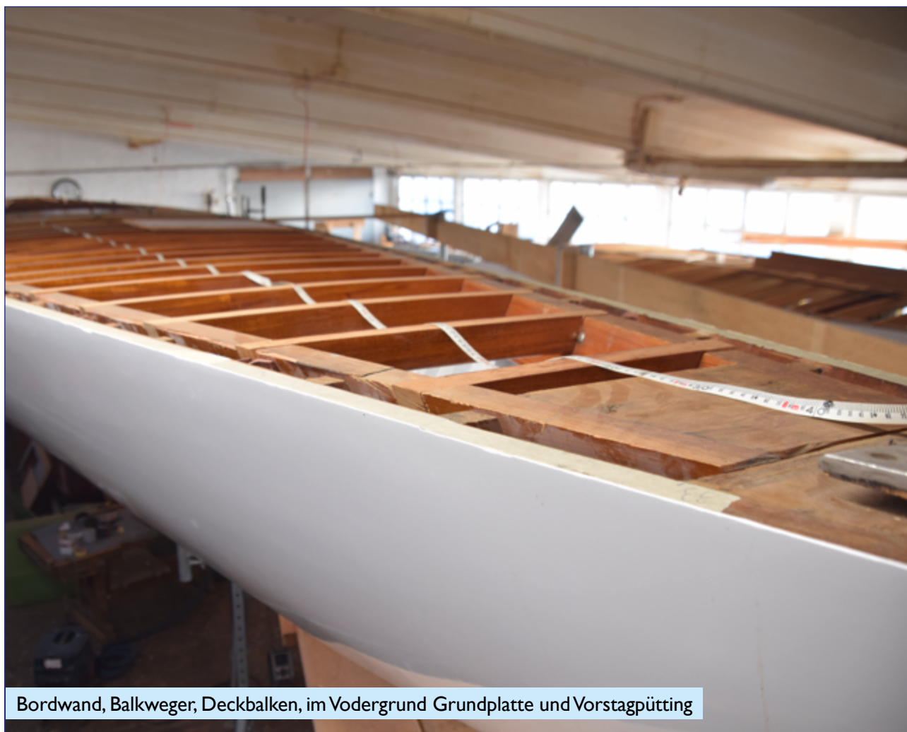
Blick von unten in das Vorschiff mit montierten Decksbalken
