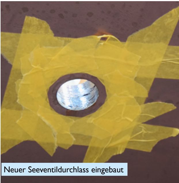
Neuer Seeventildurchlass fertig eingebaut
