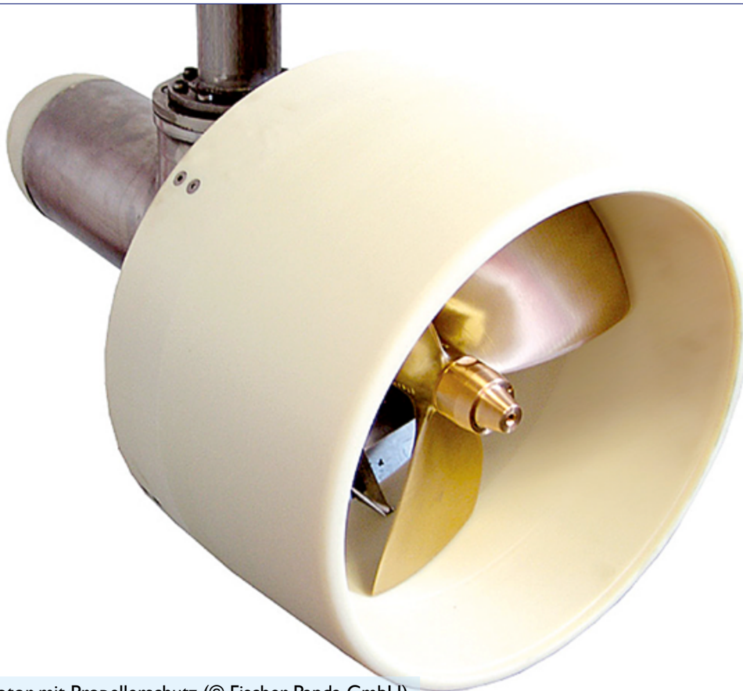
Pod-Motor mit Propellerschutz (© Fischer Panda GmbH)
