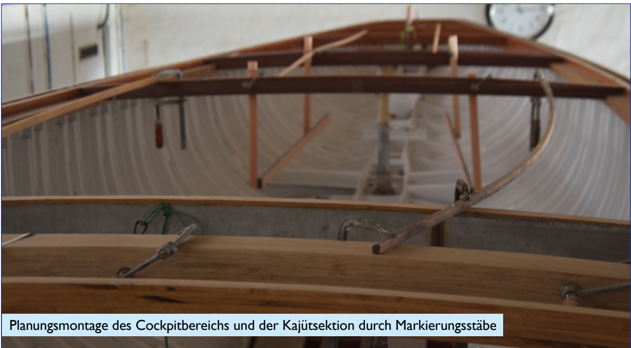
Blick in das Vorschiff mit montierten Decksbalken
