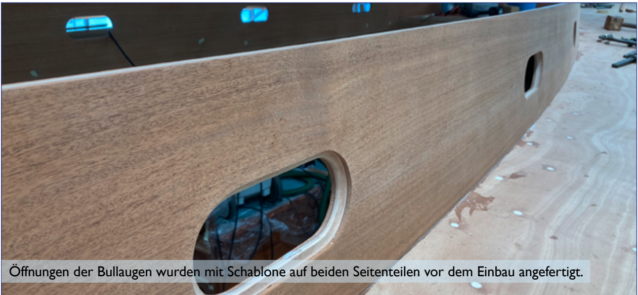
Beide Seitenteile der Kajüte sind fest montiert (10. Juli 2025). Vorderer Süllrand ist sichtbar.
