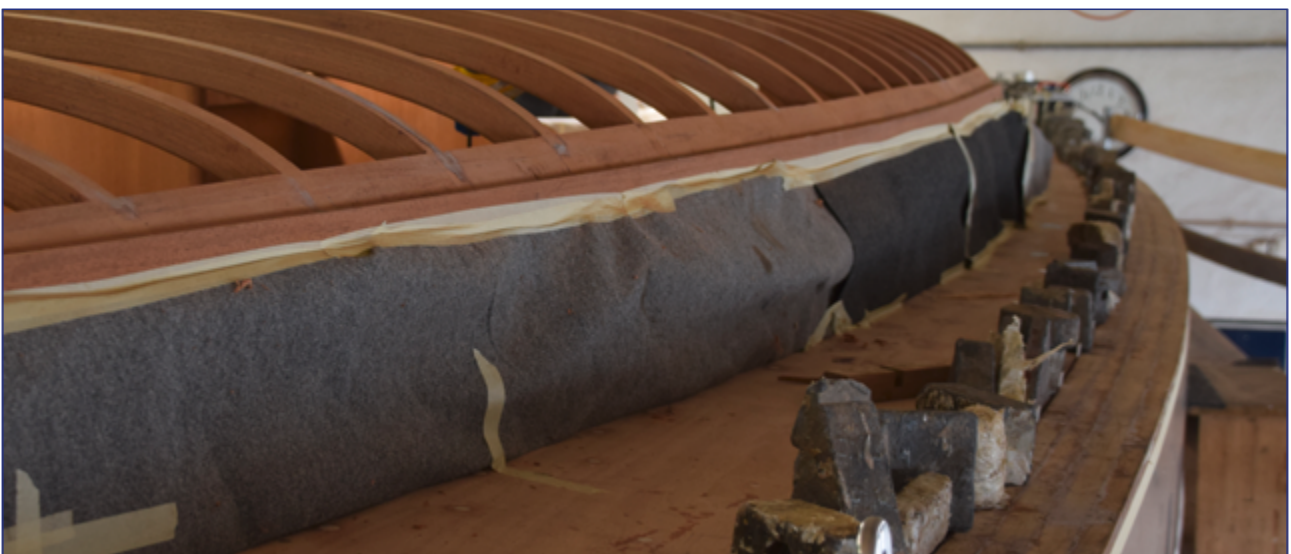
Scheuerleiste, Süllrand mit Wasserablauf (Modell 1:1)
