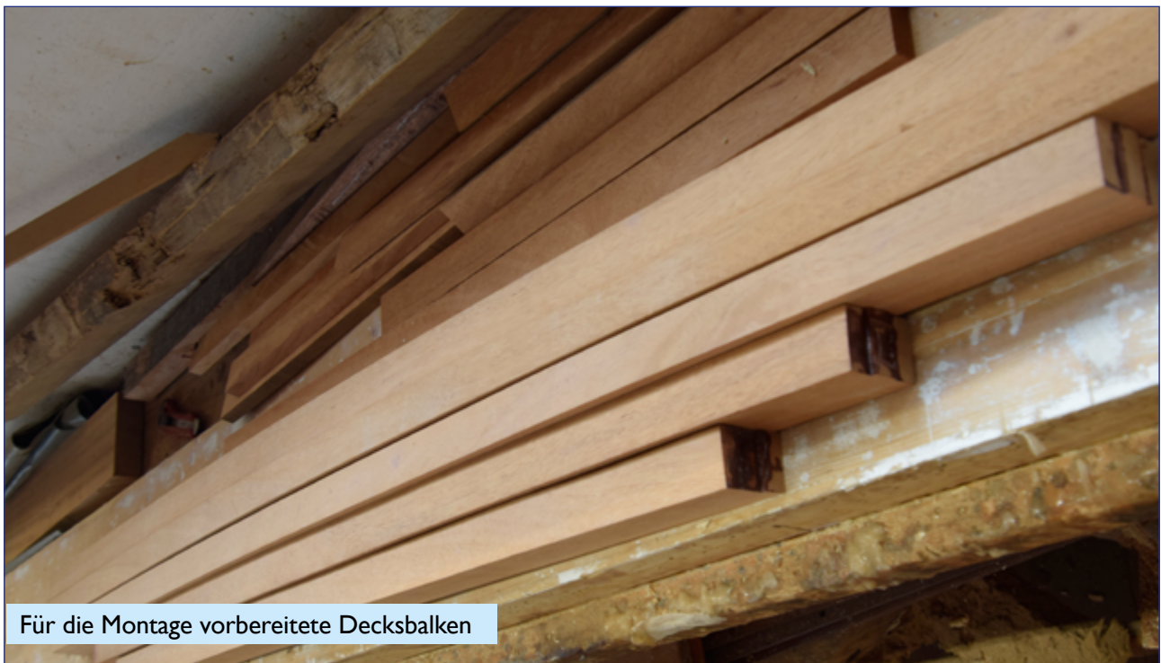
Decksbalken, im Vordergrund die Vorstagplatte
