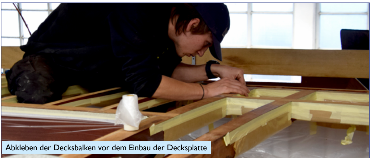
Abgeklebte Decksplatte um das Achtercockpit
