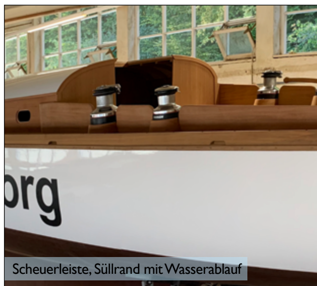
Scheuerleiste, Süllrand mit Wasserablauf (Modell 1:1)
