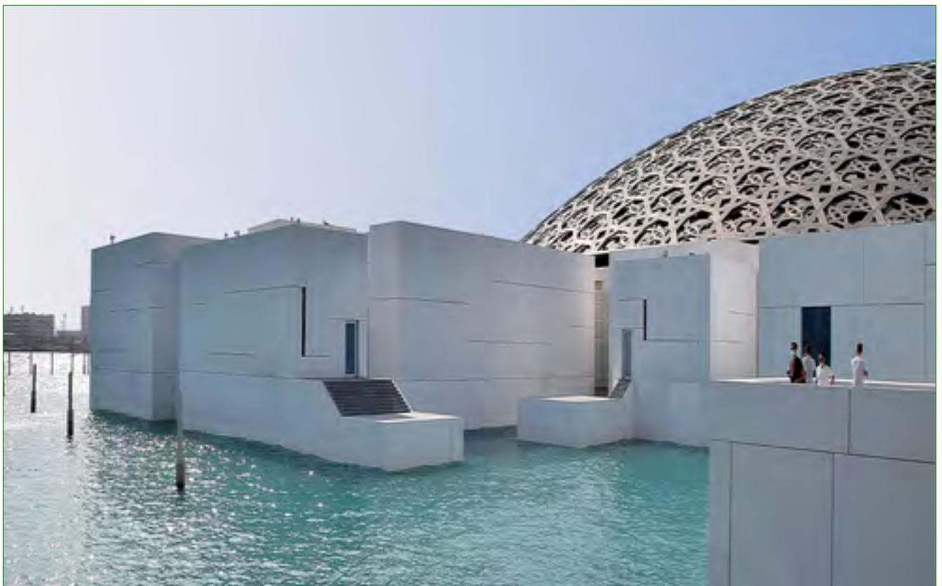
*Die Steinverkleidungen des Louvre benötigen ständige Reinigungsarbeiten durch Reinigungspersonal, das mit Flößen am Museum entlangfährt. Nur dadurch bleibt der weiße Eindruck der Mauern erhalten.*
