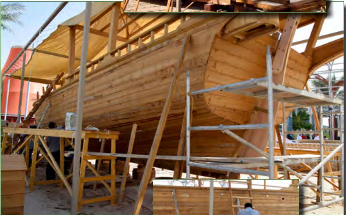
Das Schiff wurde komplett aus Holz gebaut, das aus Indien geliefert wurde. Im gesamten Schiff wurde kein Metall in irgendeiner Form verarbeitet. Die Bauzeit für ein solches Schiff beträgt normalerweise etwa 1,5 Jahre. – hier musste deutlich schneller und in Schichten gearbeitet werden, damit das Boot am Ende der EXPO wie geplant fertig wurde.
