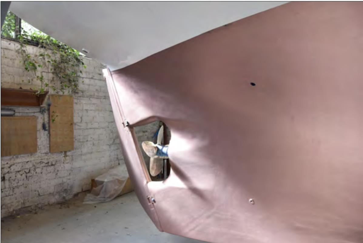
Bug- und Heckbereich nach der Beschichtung/Lackierung
