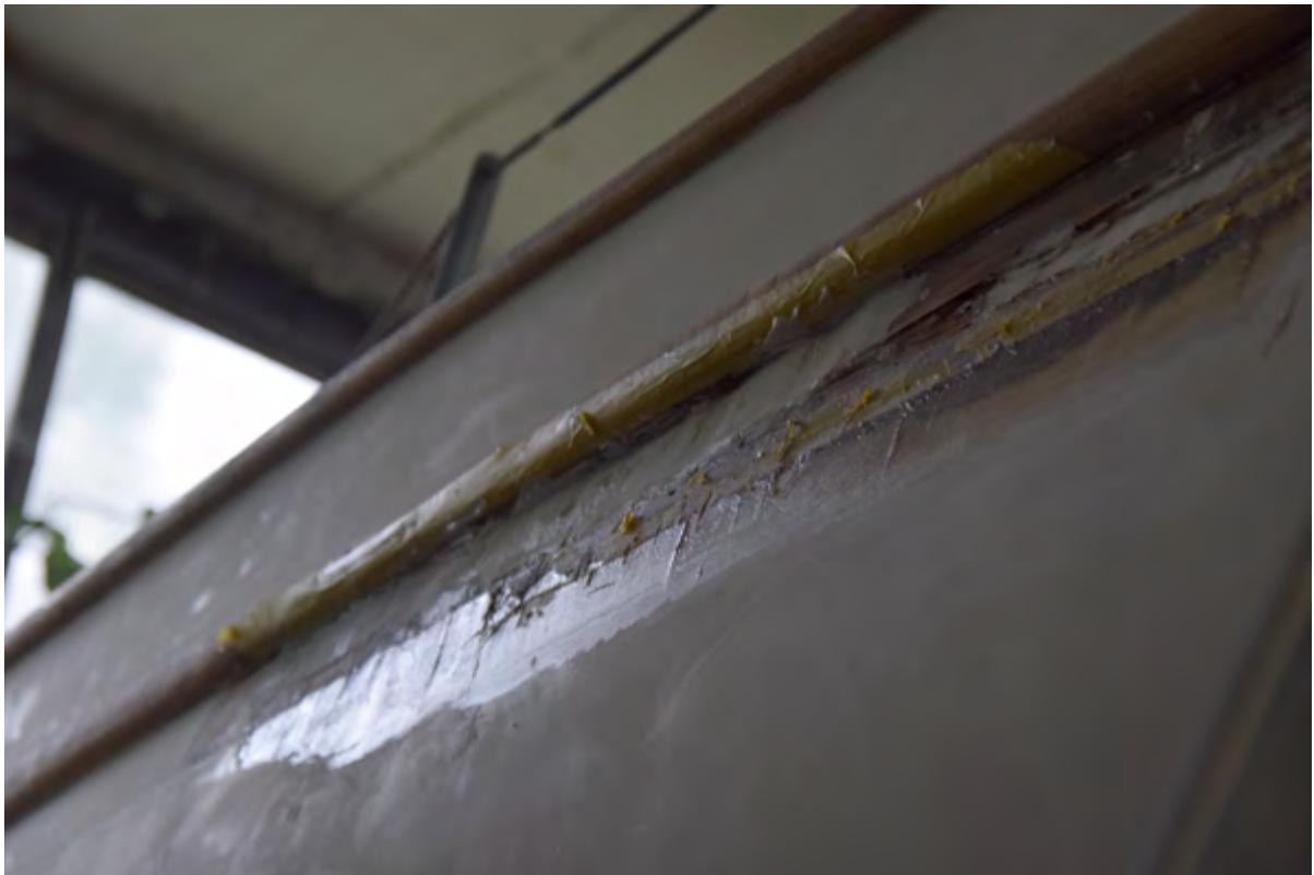
Grundierung der offenen Bordwand mit Harzgrundierung
