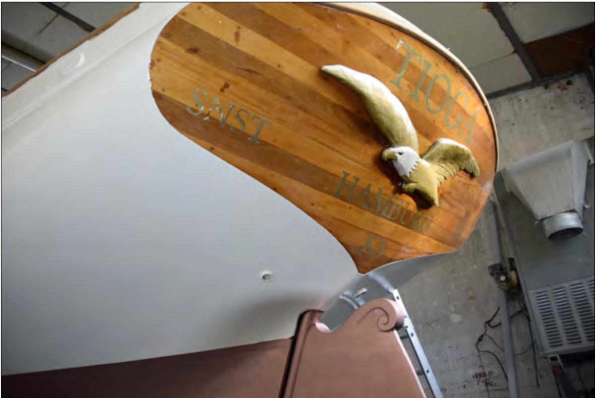
Heckbereich nach der Beschichtung/Lackierung
