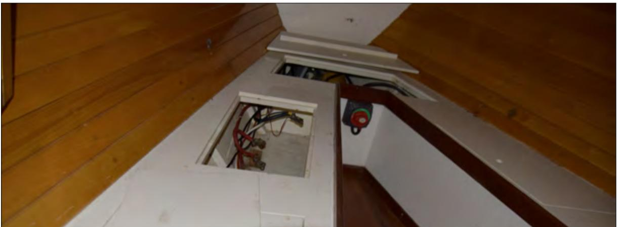
Kabelkanal in einem der Schränke und Kabelverlauf bis zur Batterie Bugstrahlruder
