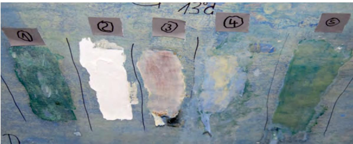
Wenig ergiebige Testreihen zur Entfernung der Antifoulingschicht
