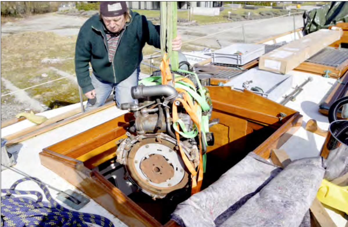
Herausheben des Motorblocks aus dem Schiff durch das Kajütdachfenster
