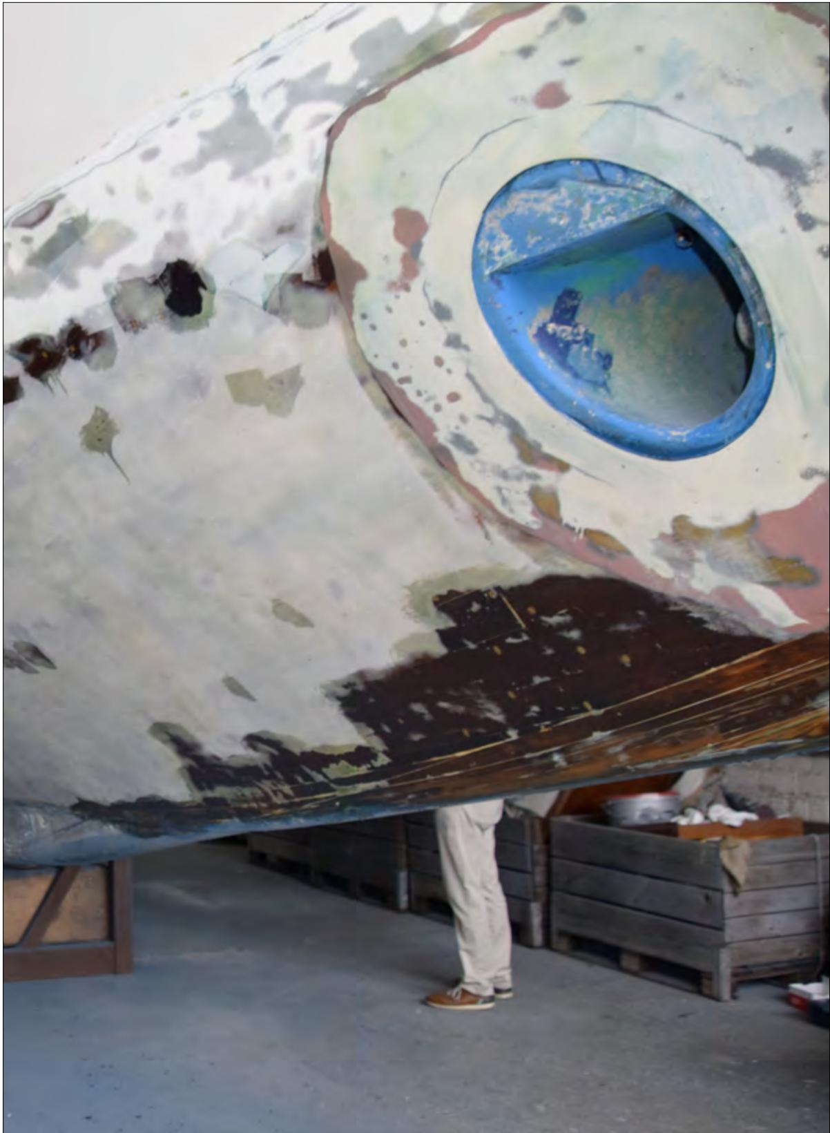
Unterwasserschiff abgeschliffen, Blick vom Bug – Stand 22.09.2020
