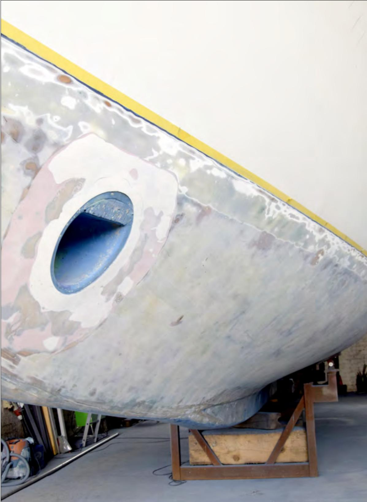
Unterwasserschiff am Bug nach dem Abschleifen
