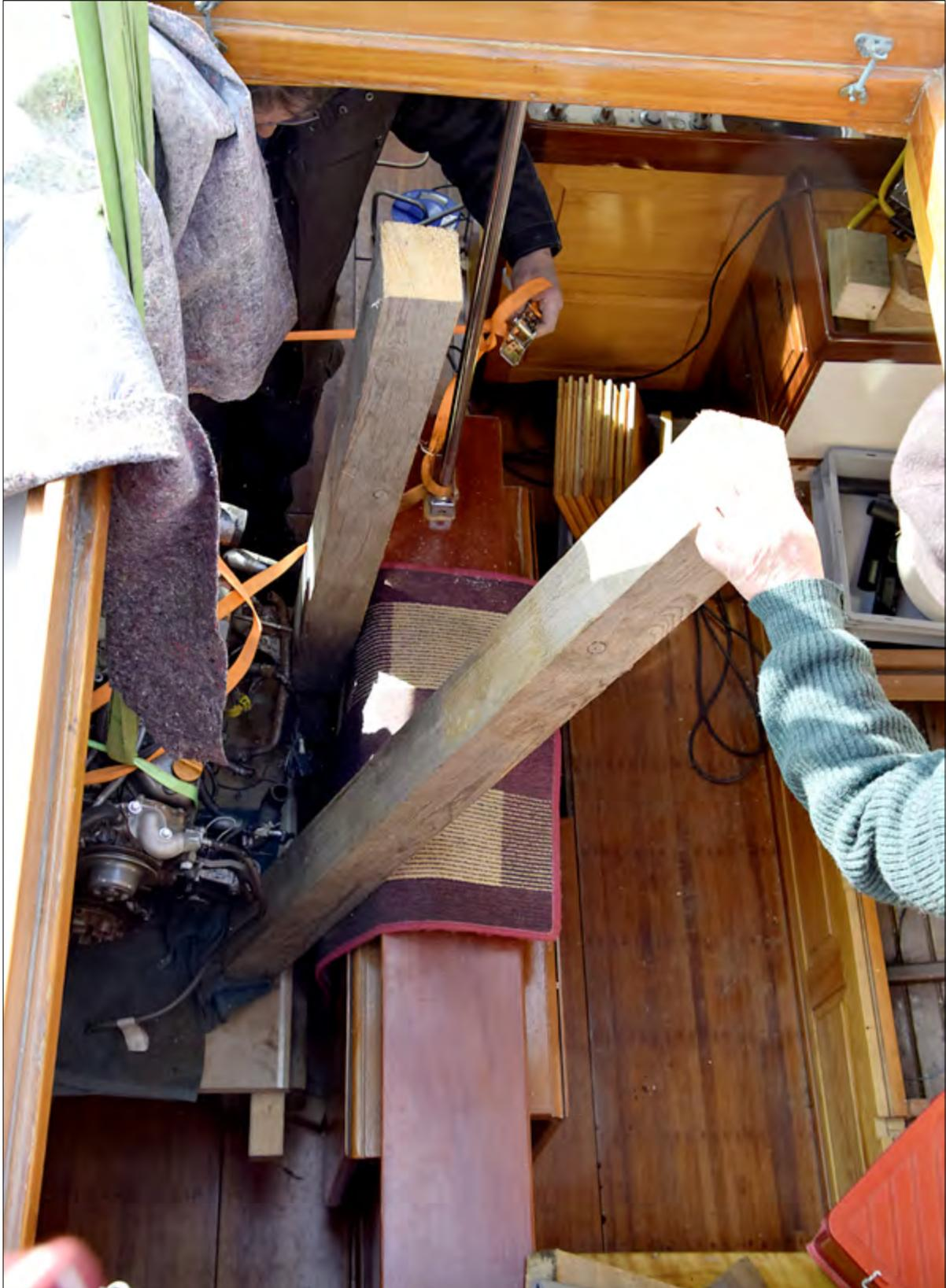
An den „Holzschienen“ läuft der Motor nach oben
