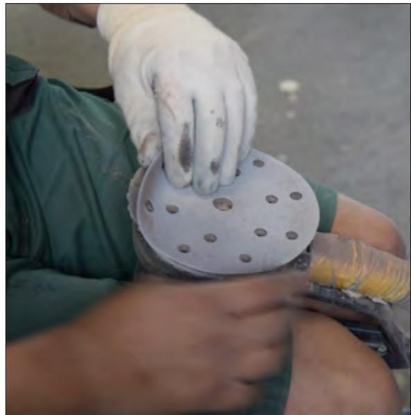
Abschleifen bzw. Aufrauen nach der sechsten Beschichtung mit **Prodotex** Epoxydharz. Vorbereitendes Aufrauen für das Aufbringen einer Antifouling-Beschichtung auf das Unterwasserschiff.
