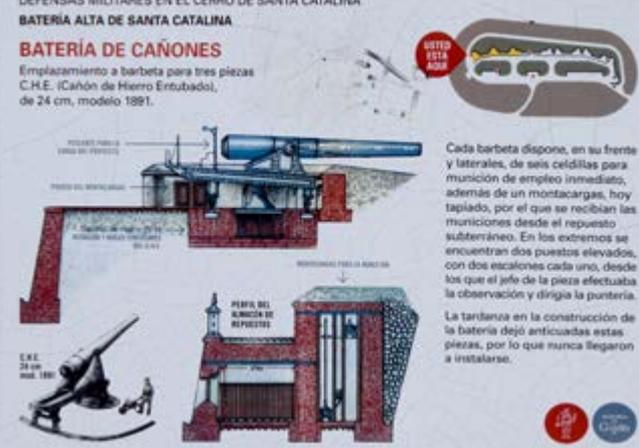
Cada barbata dispone, en su frente y laterales, de seis celdillas para munición de empleo inmediato, además de un montacargas, hoy tapiado, por el que se recibían las municiones desde el repuesto subterráneo. En los extremos se encuentran dos puestos elevados, con dos escalones cada uno, desde los que el jefe de la pieza efectuaba la observación y dirigía la puntería.
